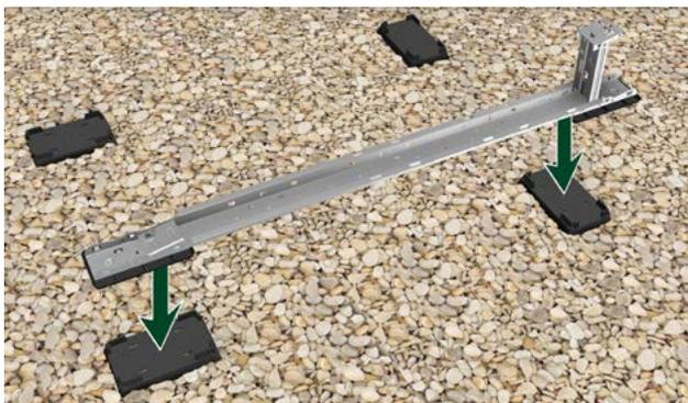
3. Coloque las zapatas del SL Fast Flat en la abertura correspondiente de la zapata para cubiertas de grava.
