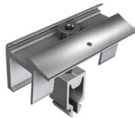
**Pinzas finales** con clavija de puesta a tierra para una altura del marco de 28 mm - 45 mm
