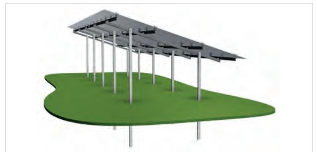
Coloque los adaptadores como se especifica y, a continuación, fije los módulos con las abrazaderas.
