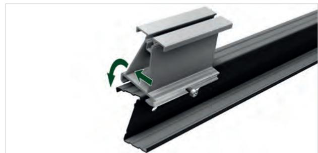
Alinee el adaptador con el tornillo hacia arriba. A continuación, pliéguelo sobre la correa Z de arriba abajo.
