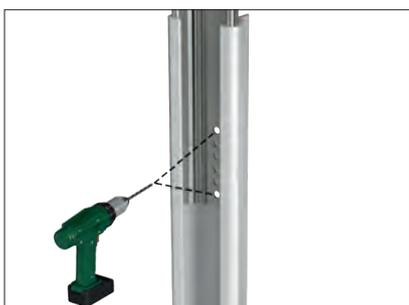
3. Utilizando los orificios existentes (perfil de acero de la viga en W), taladre a través del perfil de plástico de la viga en W con un taladro.
