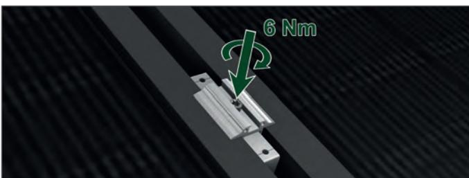
10. Encaje las pinzas intermedias, coloque el siguiente módulo y atornille en su lugar.
