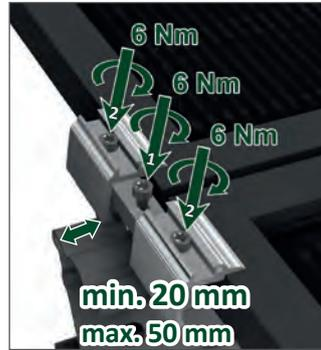
9. Encaje la pinzas finales, coloque el primer módulo encima y alinéelo según las dimensiones del dibujo de la mesa. Presione la pinza final, apriete primero el tornillo de soporte central y atornille el módulo con los dos tornillos de apriete.
